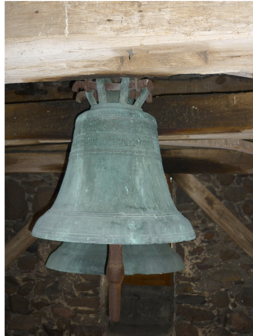
Abb. 3: Die kleine Glocke (1580). Durchmesser 0.62 m ( \approx 2 staufische Fuß; 1 Fuß = 0.305 m), Höhe mit Krone 0.60 m. Grundton f.
