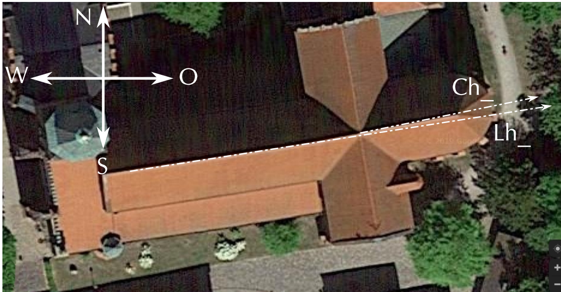
Abb. 3: Brandenburger Dom. Satellitenaufnahme 2019. Azimutwinkel Haupthimmelsrichtungen im astronomischen Horizontsystem: A(S) = 0^\circ = 360^\circ , A(W) = 90^\circ , A(N) = 180^\circ , A(O) = 270^\circ . Achsazimut des Langhauses: A(Lh_) = 261.40^\circ ; Achsazimut des Chores: A(Ch_) = 259.22^\circ .
